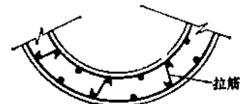
图 5.5.7 纵向钢筋与环向钢筋布置
