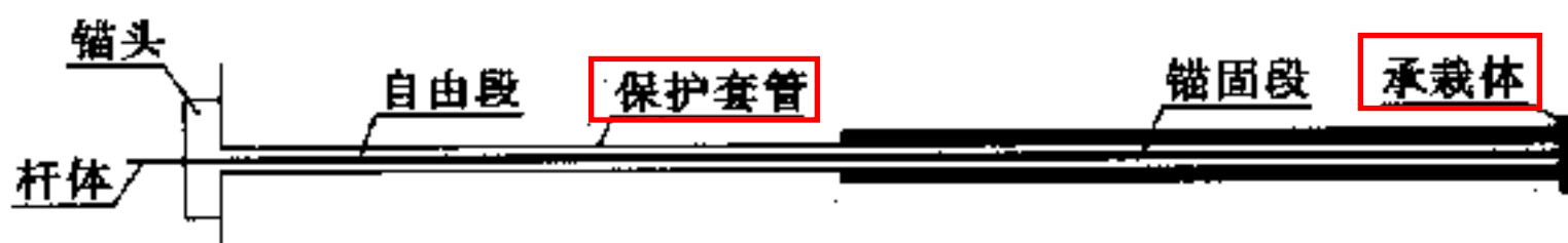
图 4.2.2 压力型预应力锚杆结构原理
